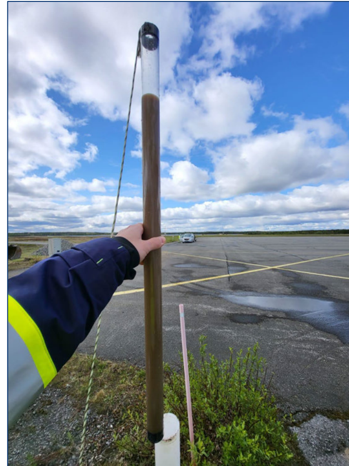
Kuva 4. Pohjavesiputken PVP2015 vesi erittäin sameaa ja hienoainepitoista.
