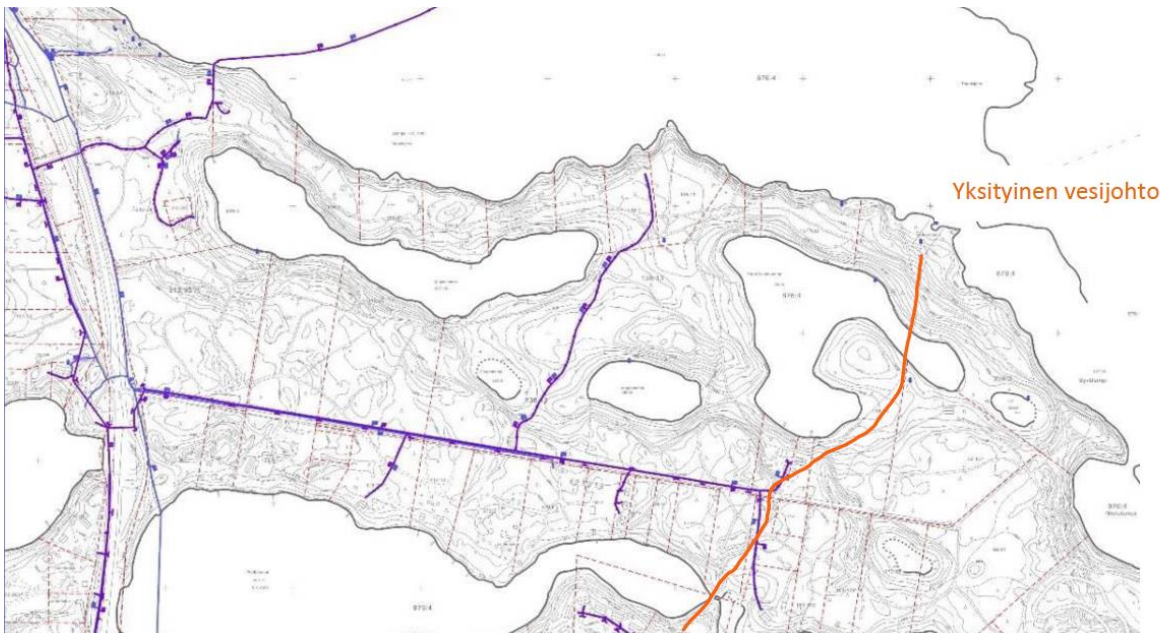
Alueen vesi- ja viemärijohdot ja pohjavesiputket.
