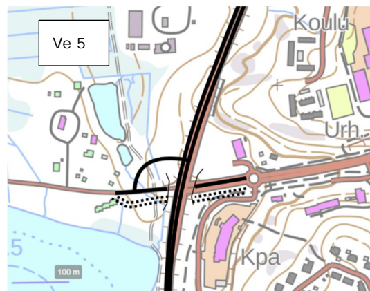
Kuva 24. Rukan pääliittymän periaatteellinen yksirampainen eritasoratkaisu (ve 5).
