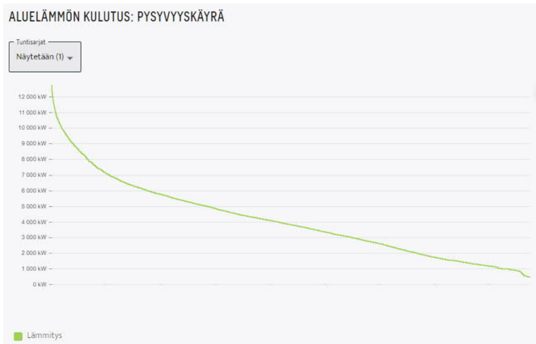
Kuva 6.2 Uudiskohteiden lämmitysenergiatarpeen pysyvyyskäyrä. Huipputehontarve on hyvin hetkellinen.
