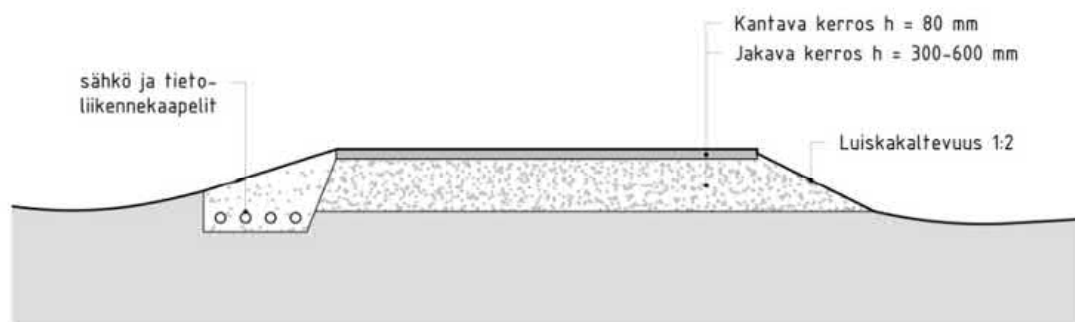
Periaatekuva uuden ja perusparannettavan tien rakenteesta.
