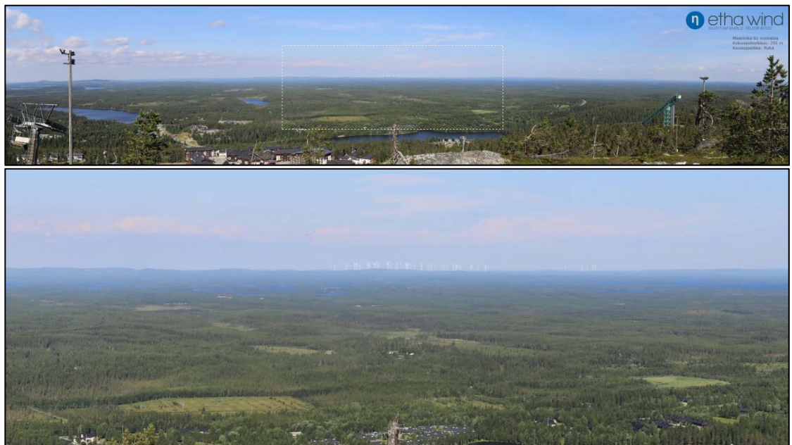
Kuva 9.18. Kuvasovite Rukan huipulta. Kuvassa on esitetty YVA:n vaihtoehdon 1 (VE 1) mukaiset voimalat. Ylempi kuva on panoraama (näkösektori 125,1°) ja alempi kuva on tarkennus panoraamasta. Etäisyys lähimpiin voimaloihin noin 27 km. Voimalat näkyvät hyvissä sääolosuhteissa kaukana taustamaisemassa kapeassa sektorissa. Maiseman muutos on vähäinen.
